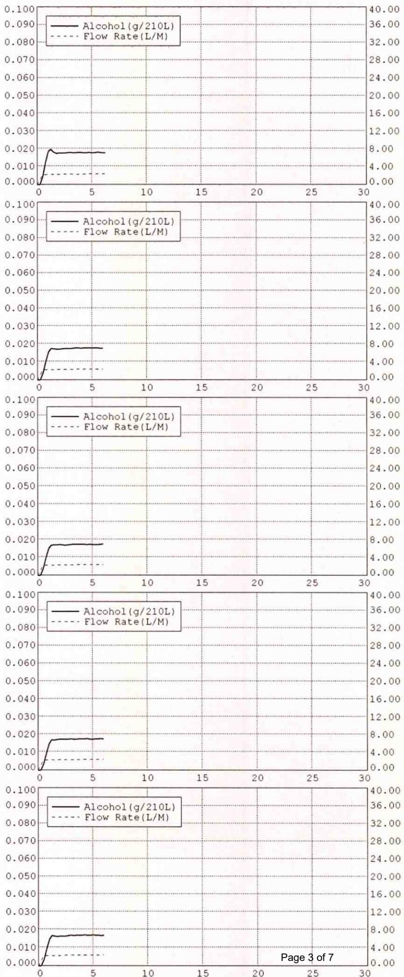
LINEARITY CHECK: Control Test 2
